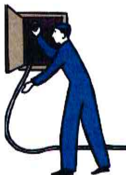
Odkręć zawór hydrantowy;
